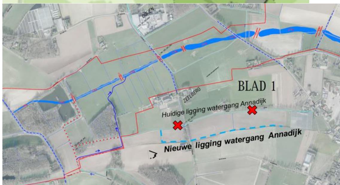
Figuur 5.62 Locatie van aangevulde slenk en verlegde watergang t.o.v. de hoge gronden.
