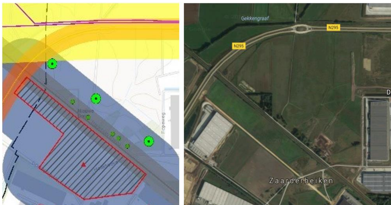
Figuur 1 Links: uitsnede belemmeringenkaart met ligging van WT-01, WT-02 en WT-03 (groen) binnen de voorkeursafstand (blauw) van de railterminal (rood omkaderd); rechts: hetzelfde gebied, luchtfoto.
